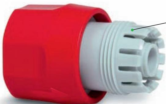
Die Absperrzähne der Kupplung sind lang und flexibel um einen optimalen Halt auch bei dünnen und schlüpfrigen Schläuche zu gewährleisten und um eine gleichmässige Druckverteilung beim Anschliessen der Kupplung zu erhalten, so dass der Schlauch durch die Absperrzähne nicht beschädigt wird beim Biegen oder bei einer Torsion.
