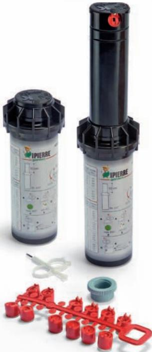
Turbinen Pop-up Einstellbarer Winkel 40° bis 360° Gew. 3/4" F, mit Reduzierstück 3/4" M bis 1/2" F.
