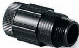
Druckreduzierer 3/4" I.G. - 3/4" A.G. Für den elektronischen Digitalprogrammierer oder für den direkten Wasserhahnanschluss. Ausgangsdruck 1 bar. Durchfluss bis 25 l/min.
